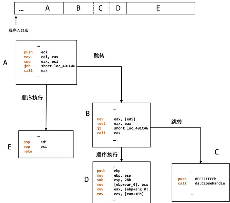
图 2 执行导向的操作码序列提取
