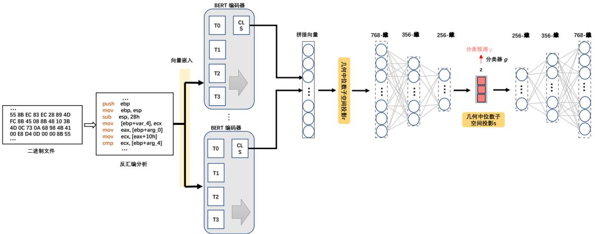
图 1 基于 BERT 和瓶颈自编码器的恶意软件分类模型系统架构
